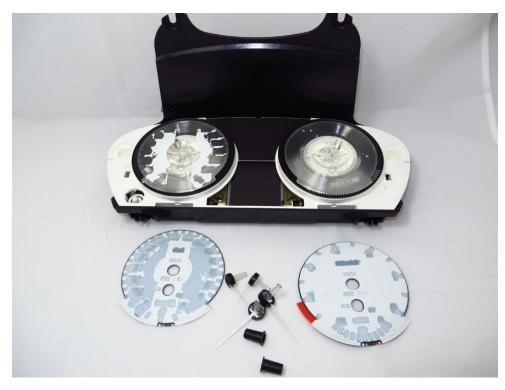
Jetzt können Sie die Tachoscheiben abziehen. Diese sind geklebt und sitzen etwas fester, können aber ganz einfach abgezogen werden. Danach sollten die Klebereste gut entfernt werden.
