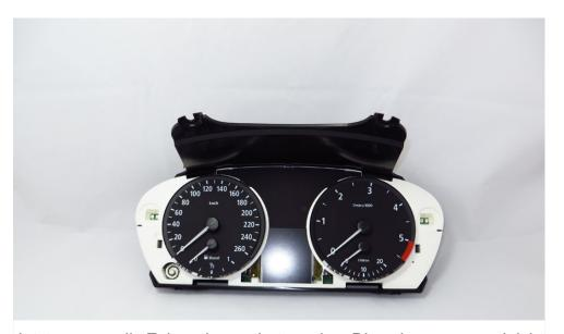
Jetzt müssen die Zeiger demontiert werden. Diese können ganz leicht angezogen werden, bitte merken Sie sich die Stellung der Zeiger, diese müssen in der ursprünglichen Position später wieder raufgesteckt werden.
