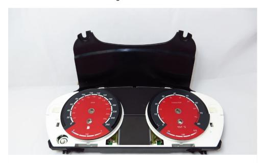
Jetzt kommen die neuen Tachoscheiben auf den Träger. Bitte fixieren Sie die Tachoscheiben komplett, am besten eignet sich dazu unser Befestigungs-Set, welches Sie direkt bei und im Shop bestellen können. Nun können Sie alles in umgekehrter Reihenfolge wieder montieren.
