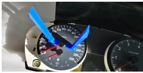
Auch hier kommt wieder unser Hebelwerkzeug zum Gebrauch, einfach rechts und links unter den Zeiger und langsam mit Hilfe der Hebelwirkung nach unter drücken. Der Zeiger löst sich so ganz einfach.
