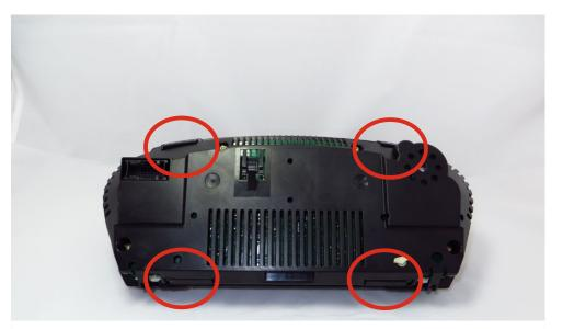
Sie sehen die Rot eingekreisten Klipse, diese oben und unten gleichmäßig vorsichtig runter drücken und somit das untere Gehäuse von der Scheibe trennen. Sie benötigen nun den unteren Teil. Dieses gelingt perfekt mit unserem Hebelwerkzeug.
